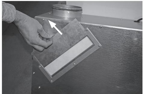
Jetzt können die Profi-Aktivkohlefilter P 220 eingesetzt werden. Anschließend Filterdeckel wieder einschieben.
