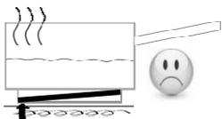
Ferromagnetisches Element wurde schlecht eingebaut
