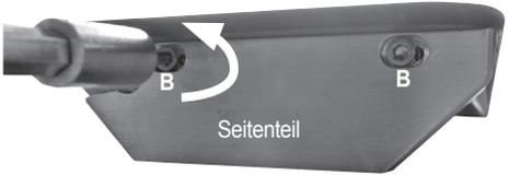
Anschließend können die beiden Seitenteile im Rahmen der Langlöcher verschoben und nach erfolgter Feinjustage durch Drehen der Schrauben (B) nach rechts (im Uhrzeigersinn) wieder festgezogen werden. Die Schrauben sind dabei handfest anzuziehen.
