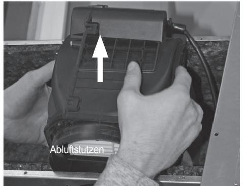
Gebläsemotor so drehen, dass Abluftstutzen nach unten weist (1).
