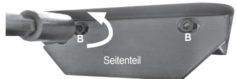
Anschließend können die beiden Seitenteile im Rahmen der Langlöcher verschoben und nach erfolgter Feinjustage durch Drehen der Schrauben (B) nach rechts (im Uhrzeigersinn) wieder festgezogen werden.
