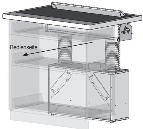
4 einzeln verstellbare Standfüße erlauben eine problemlose horizontale Ausrichtung des Motorblocks.
